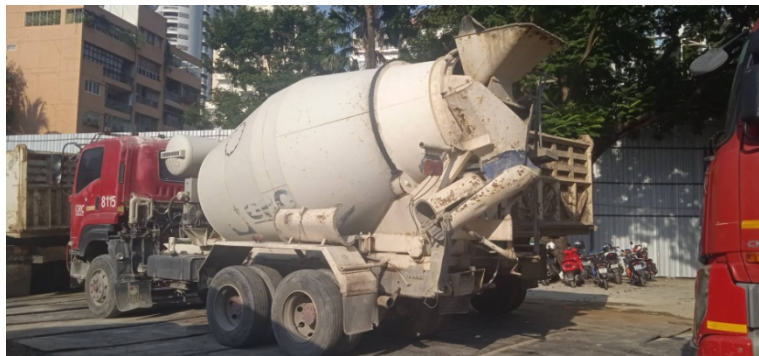
ภาพที่ 5-23 ใช้ปูนซีเมนต์ผสมเสร็จ จากรถผสมคอนกรีต
