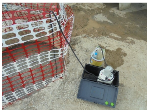
ภาพที่ 6 การติดตั้งเครื่องตรวจวัดคุณภาพสิ่งแวดล้อม และเก็บตัวอย่างน้ำทิ้ง (บริเวณด้านทิศตะวันตก และเครื่องตรวจวัดความสั่นสะเทือนขยับไปตามทิศทางการทำเสาเข็ม)
