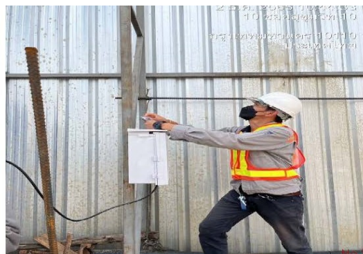
ภาพที่ 5-25 เข้าร่วมโครงการตรวจวัดฝุ่นละอองของสำนักสิ่งแวดล้อมกรุงเทพมหานคร เข้ามาติดตั้งอุปกรณ์ตรวจวัดฝุ่นละออง
